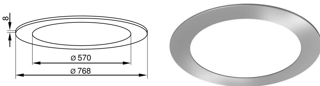
Der Deckenabschluss ist optionales Zubehör. Er wird nur benötigt, wenn die Streuscheibe bündig mit der Decke abschließt.
