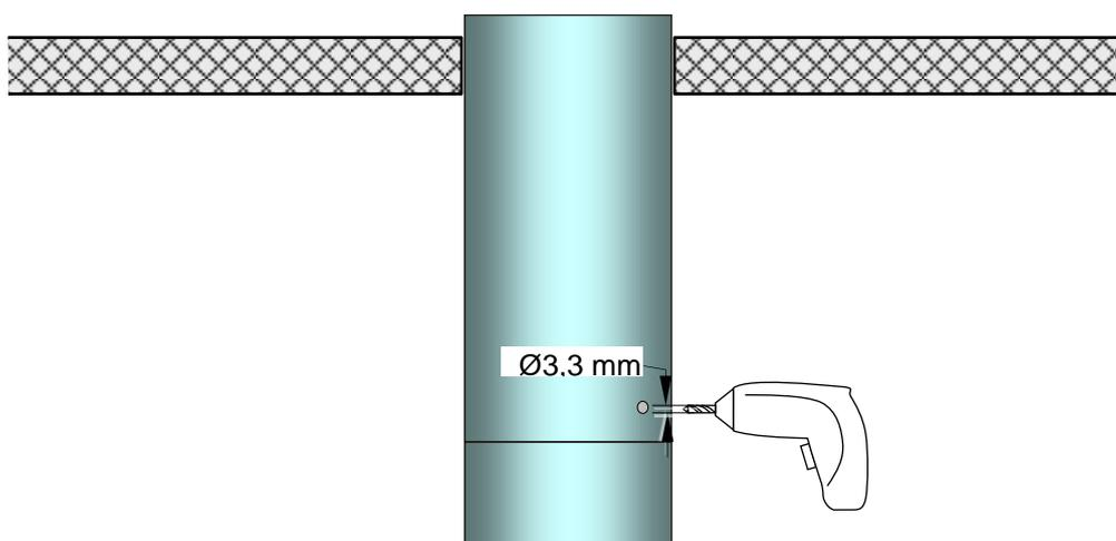
Beide Röhren mit 4 bzw. 6 Stück Al-Blindniete dampfdicht  $\text{Ø}3,2 \times 6$  verbinden (im Lieferumfang enthalten).
