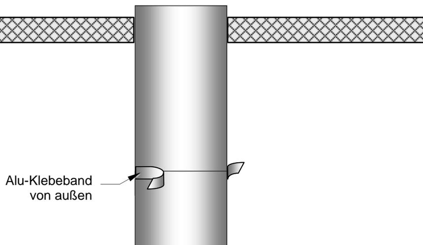
Stoß außen mit Alu-Klebeband reflektierend, Breite 25 mm, Länge 112 cm bzw. 150 cm dampfdicht abkleben. Alu-Klebeband ist im Lieferumfang enthalten
